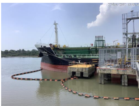
ภาพที่ 2-6 การล้อมทุ่น (Boom) รอบลำเรือบรรทุกน้ำมัน
